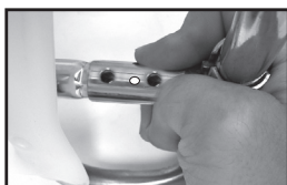
Figure 2 Alignez les trous
